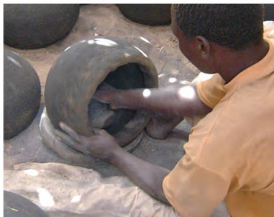
Fig. 11. Martelage sur support en bois. Le potier part d'une « galette » d'argile qu'il creuse, arrondit et élargit par percussion à l'aide d'un marteau en terre cuite, en progressant du centre vers la périphérie. Dans cette variante du martelage, le bord de l'ébauche constitue un bourrelet qui est progressivement aplati et étiré.
